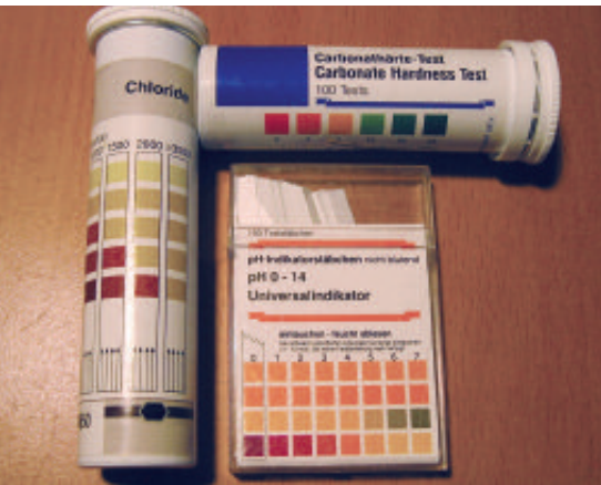
Abb. 2 Papierteststreifen zur Wasserprüfung
