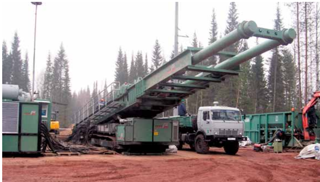
Die Prime Drilling Bohranlage PD 450/150 AM ist mit einer Zugkraft von max. 450t und einem Drehmoment von 150 kNm die leistungsstärkste Horizontalbohranlage in Russland.
