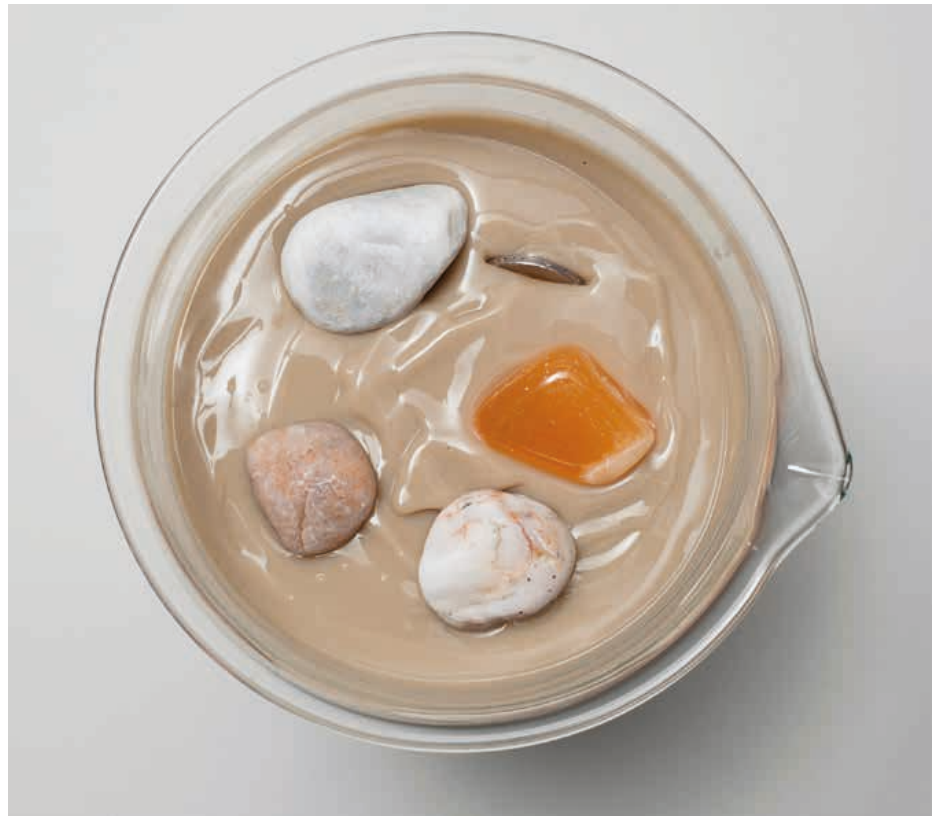
Bohrspülung muss an den Baugrund angepasst werden, nicht an die Möglichkeiten der Recyclingsysteme.
